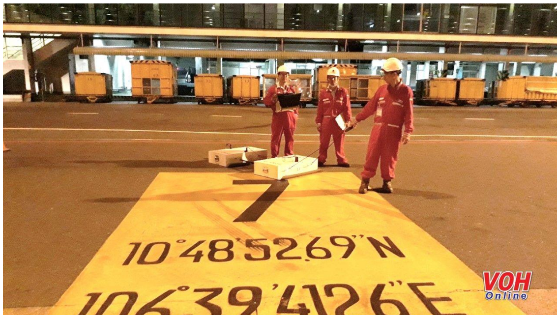
Khảo sát sụt lún và công trình ngầm bằng phương pháp GPR trong sân bay Tân Sơn Nhất (Ảnh: TS. Đặng Hoài Trung cung cấp)
